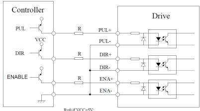
R=0 if VCC=5V; R=1K(Power>0.125W) if VCC=12V; R=2K(Power>0.125W) if VCC=24V;
